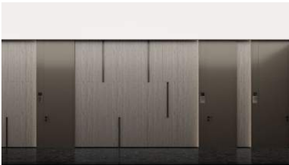
Slika 19: Prikaz karakterističnog zida hodnika (kamena obrada, BARISOL plafon, ALU pauze i obrada vrata sa oznakama prostorija)
